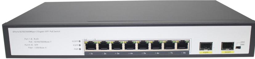
千兆 2 光 8 电 POE 光纤交换机，支持 8 个 10/100/1000M 以太网数据互联，同时支持通过 5 类以太网线给网络监控设备，无线访问点 (AP) 等设备供电，PoE 端口供电符合 IEEE802.3at 和 IEEE802.3af 标准，网线传输距离 250 米。设备支持 2 个千兆 SFP 端口，可插拔 1.25G SFP 光模块，通过光纤与上联交换机互联。
