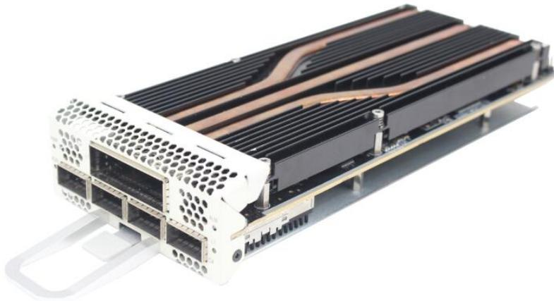
400G Muxponder 板卡,支持 4 路 100G 业务透明传送,可将 4 路 100G 业务信号转换成 1 个 400G DWDM 标准波长的相干光信号。
