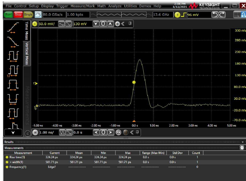
图 3-3 PD2100 脉冲响应曲线
