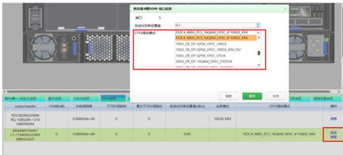
点击板卡视图，在菜单栏中点击“DDM 信息”，在信息表格最右侧点击修改选项，在弹出的窗口中可以设置 CFP2 调试模式，根据使用光模块的型号选择对应的模式点击提交，其中模式后缀带“KR4”或“FEC”即支持 FEC 模式；模式后缀为 100GE 的是不带 FEC。
