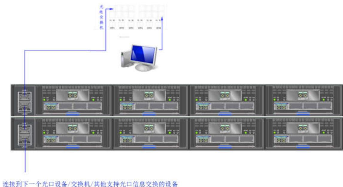
图 1-1 1U 设备的网口连接示意图
